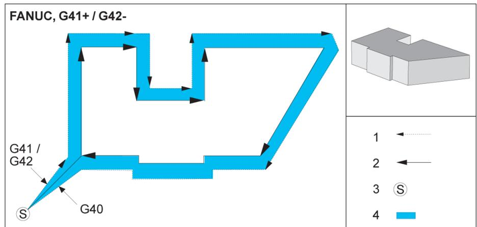
**Improper Cutter Compensation:**
